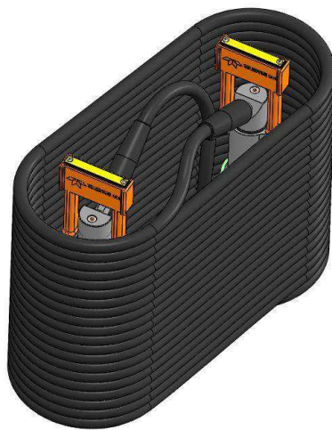
Figura 6: Enrolamento elíptico do Jumper (isométrico)
